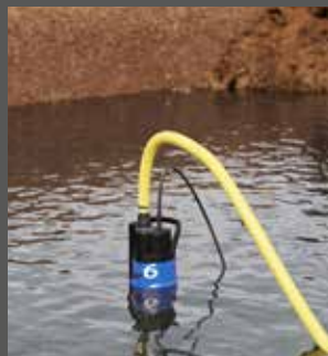
■ Do wypompowania wody z wykopów budowlanych
